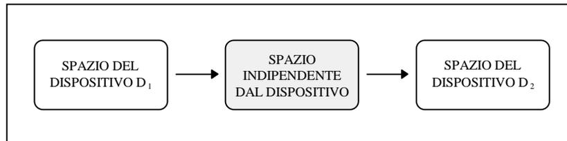
**Figura 3** Schema del processo di trasferimento di un colore tra due dispositivi,  $D_1$  e  $D_2$ , caratterizzati colorimetricamente.
